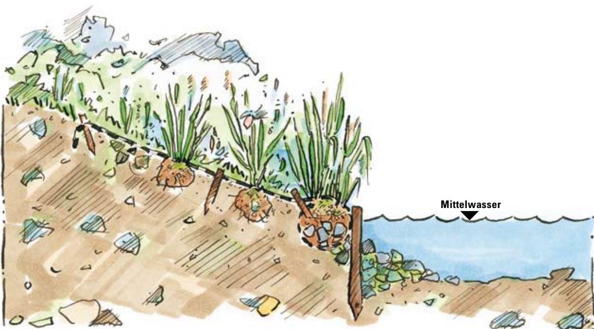
Abb. 4.37: Vegetationswalze in Kombination mit Böschungsschutzmatte nach drei Monaten
