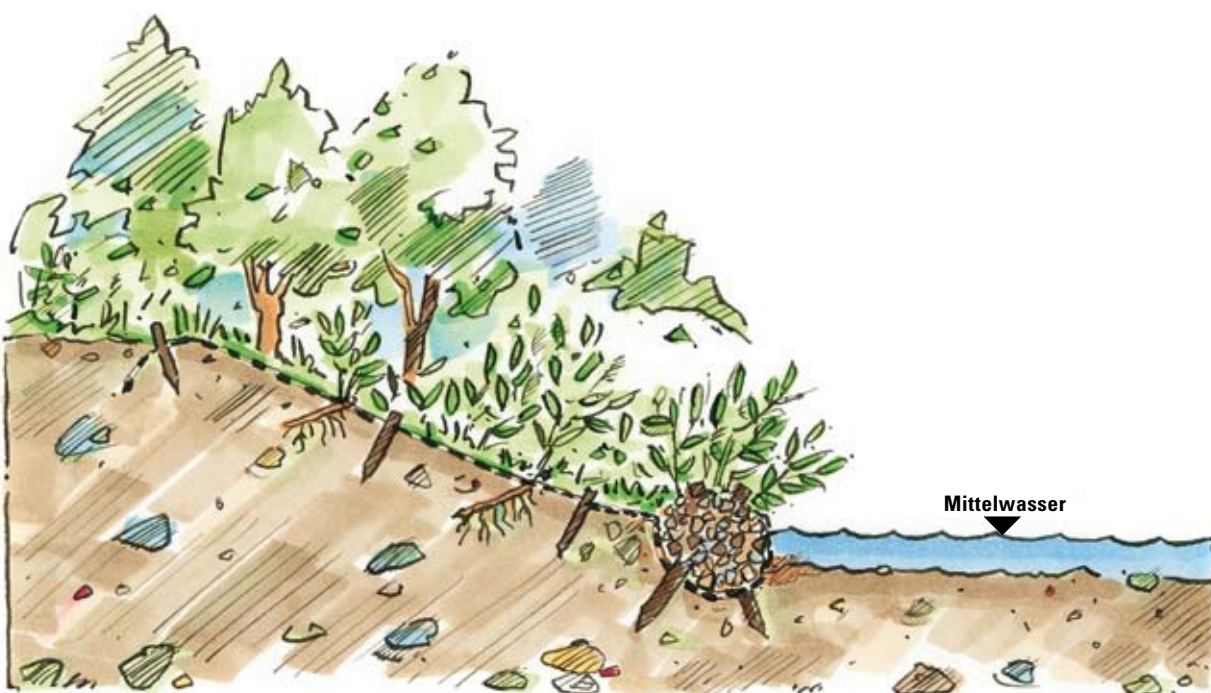
Abb. 4.40: Böschungsschutzmatte in Kombination mit Faschinen-Fußsicherung, Herstellungszustand
